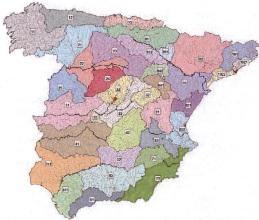
FIGURA 2.9.- REGIONES CONSIDERADAS PARA LA CARACTERIZACIÓN DEL COEFICIENTE CORRECTOR DEL UMBRAL DE ESCORRENTÍA
